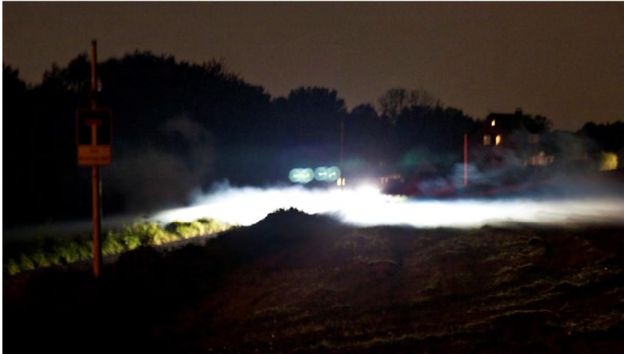
Abb. 34 Strömungsversuche mit einer Nebelmaschine am Standort Buschfeld
